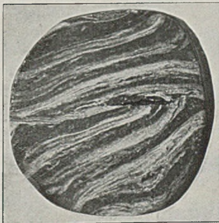
Abbildung 4. Aetzschliff des Ketteneisens, Querschnitt.
