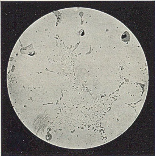
Abbildung 24. Schwefelmangan-Seigerung, Probe ungeätzt.
