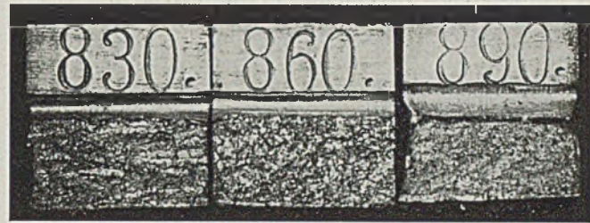
Abbildung 18. Bruchgefüge der Schlagproben.
