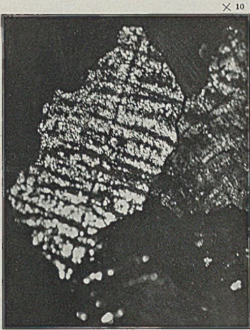
Abbildung 3. Schliff eines Kristallgebildes aus dem Lunker eines Blockes.
