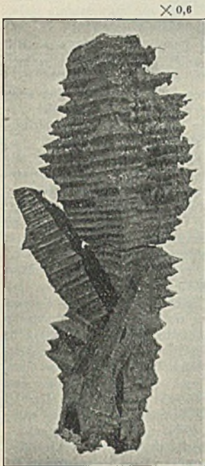
Abbildung 1. Kristallgebilde aus dem Lunker eines 12-t-Blockes.
