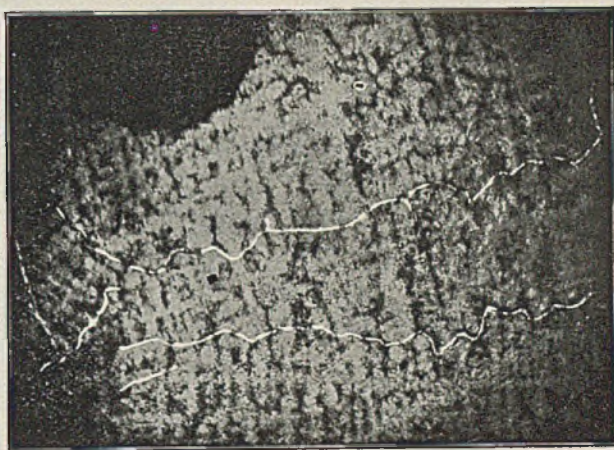
Abb. 5. Netz von Ferrit zwischen den Dendriten. 0,60 % Kohlenstoffgehalt.
