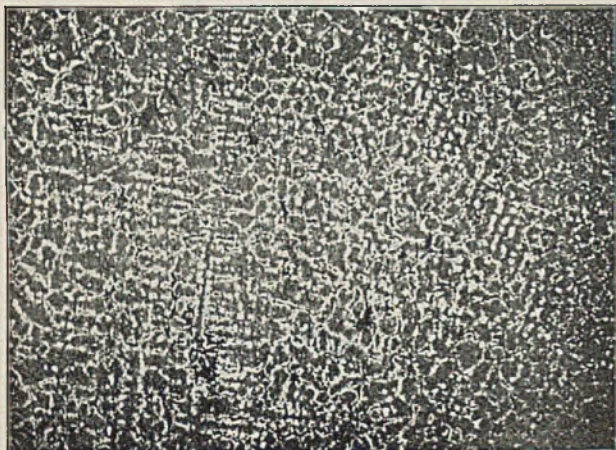
Abb. 4. Struktur der großen Kristalle. 2,27 % Kohlenstoffgehalt.
