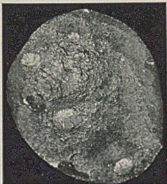
Abbildung 13. Bruchfläche eines Zerreiβstabs.
