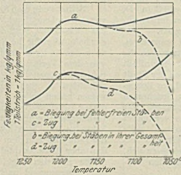
Abbildung 1. Einfluß der Gießtemperatur auf Zug- und Biegefestigkeit.
