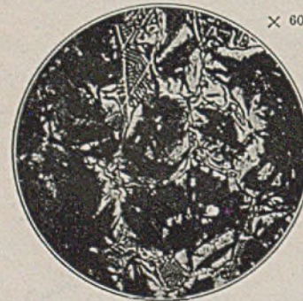
Abb. 22. Probe wie bei Abbildung 21; mit Salpetersäure in Amylalkohol geätzt; dunkle Nadeln auf hellem Grunde, helles Eutektikum.
