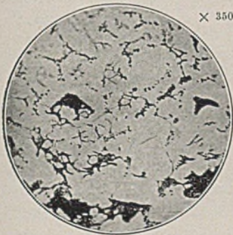
Abbildung 28. Probe geschmiedet, gegläht und aus beginnender Schmelztemperatur gehärtet. 1 Stunde mit Salpetersäure in Amylalkohol geätzt; C = 0,57 %, W = 17,21 %, Cr = 6,60 %, Mo = 0,10 %.
