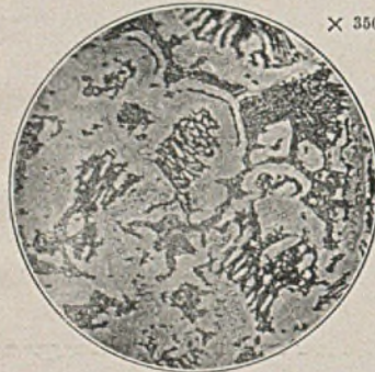
Abb. 19. Wärmebehandlung wie bei Probe Abb. 15; C = 0,44 %, W = 17,16 %, Cr = 4,42 %, 1 Stunde mit Salpetersäure in Amylalkohol geätzt.
