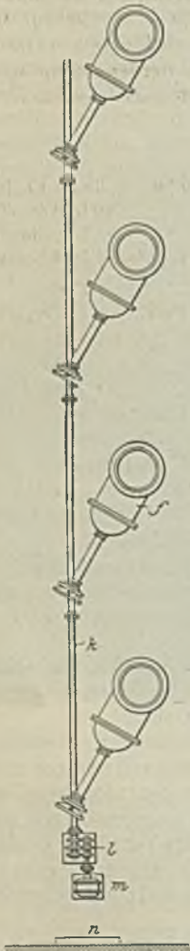
Abb. 15. Anordnung einer Regulierung, Patent Zschocke.
