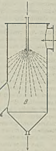
Abbildung 2. Gichtgasreiniger nach Dr. Kublerschky.
