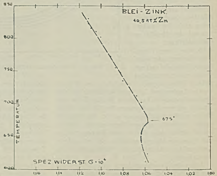
Abb. 3. Temperatur-Leitfähigkeitskurven einer sich entmischenden Blei-Zink-Legierung.
