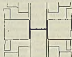
Abbildung 3. Fertigstich, zweites Gerüst. Abbildung 1 bis 3. Sack-Walzwerk.
