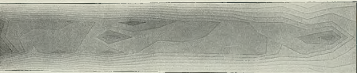
Abbildung 10. Graphische Darstellung der Verteilung des Schwefels im großen Siemens-Martinblock.
