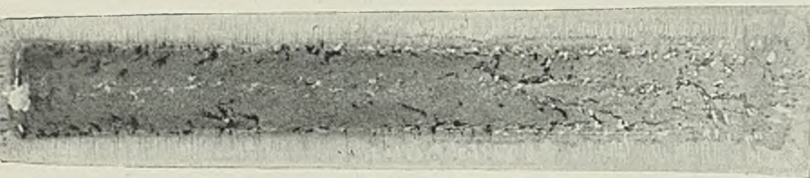
Abbildung 8. Schwefelverteilung im großen Siemens-Martinblock.
