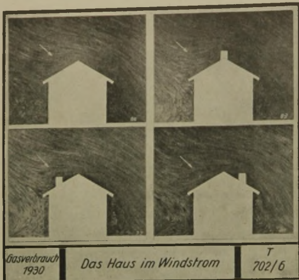
Einfluß des Windes auf die Schornsteinmündung bei verschiedener Dachform und Schornsteinstellung
