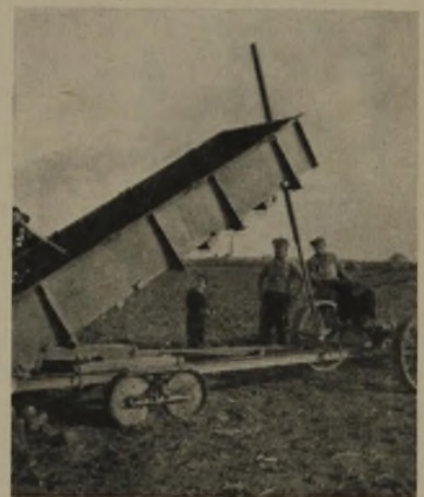
6 Universal-Tiellade-Stahlwagen mit Kippaufsatz. Rud. Sack, Leipzig
