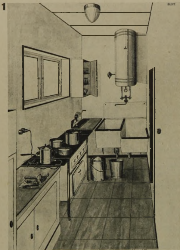
Elektr. Küche der Märk. Elektr.-Werke (MEW) „Solwa“-Herd, „Eltron“-Heißwasserspeicher, Beheizung durch Kachelofen in Trennwand (rechts, nicht sichtbar)
