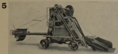
5 Straßenbetoniermaschine Selbstfahrend mit Ausleger und Verteilerkübel Jos. Vögele A.-G., Mannheim
