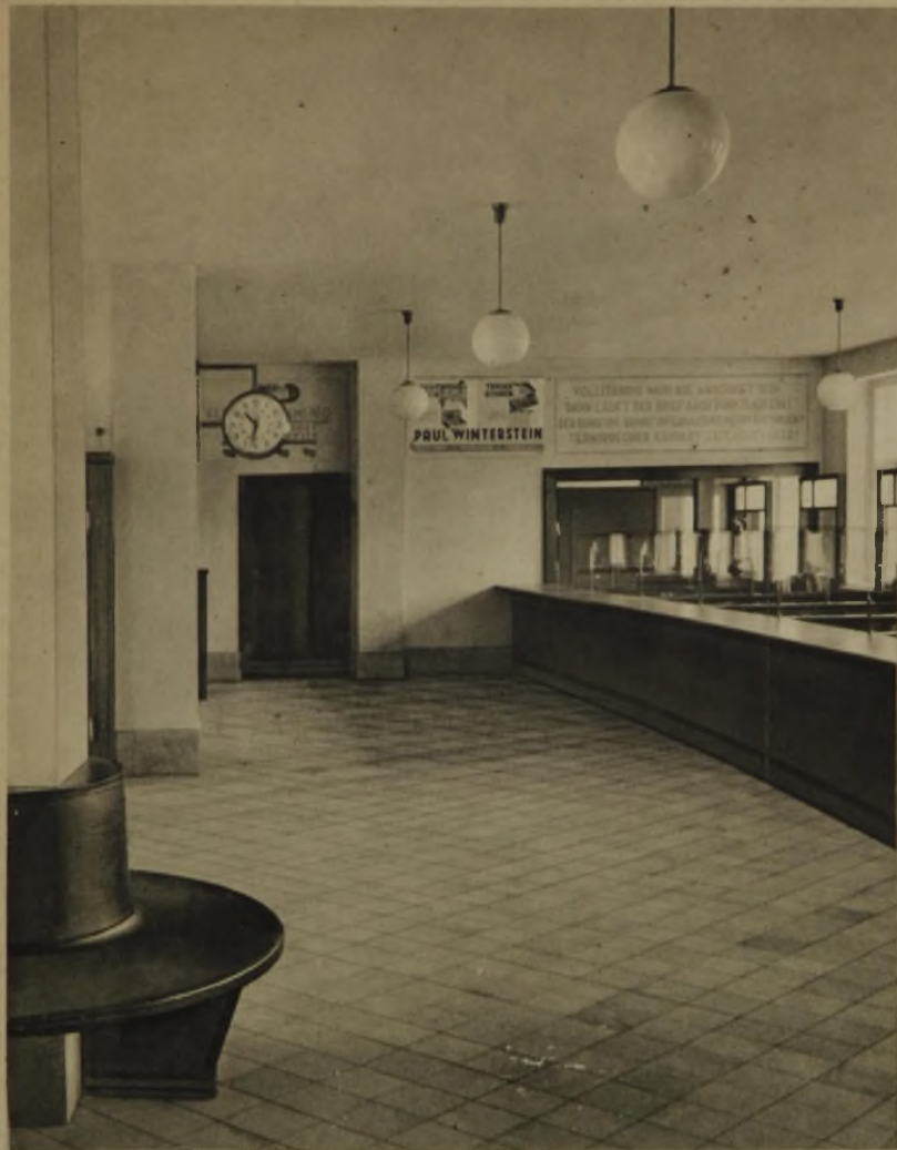
Schalterhalle. Ausstattungsgegenstände, wie Briefschalter, Wand und Decke zartgrün gestrichen. Fußboden Solnhofener Platten
