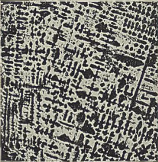
Abb. 5. Sandguß. Gußstab S (250 × 40 × 30 mm). Abb. 6. Sandguß.
