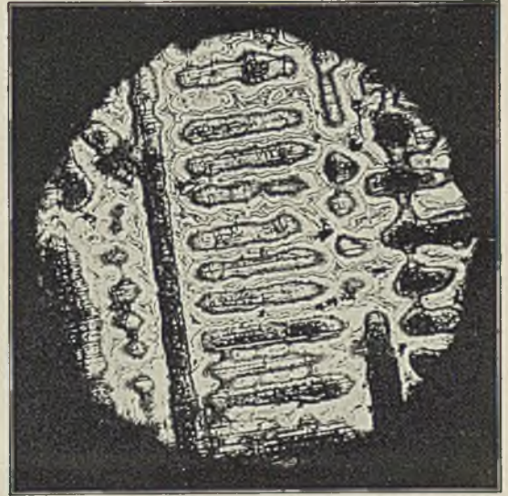
Abb. 5. Sandguß. Gußstab S (250 × 40 × 30 mm). Abb. 6. Sandguß.
