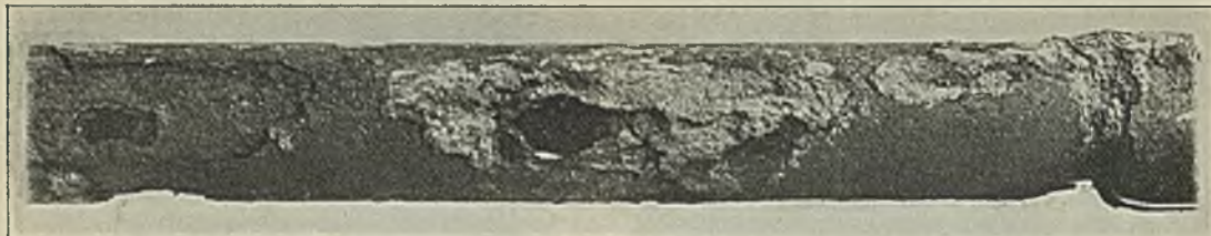
Abbildung 16. Durch vagabundierende elektrische Ströme zerstörtes Schmiederohr.
