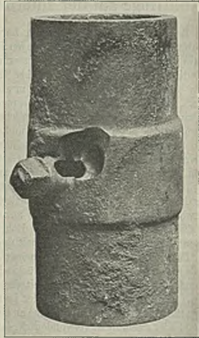
Abbildung 1. Gußrohr, durchlocht durch Wasserkraft.
