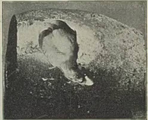
Abbildung 3. Durch Ratten angenagtes Bleiöhr.
