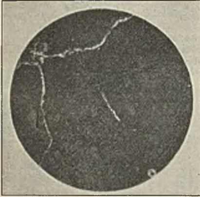
Abbildung 1. Probe aus einem stark überhitzten Radreifen. \times 50
