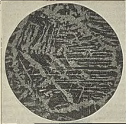
Abbildung 1. Probe mit 0,40 % Kohlenstoff; 2st lang bei 1200° C erhitzt und langsam abgekühlt. x 40
