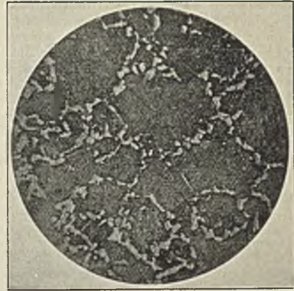
Abbildung 3. Probe mit 0,40 % Kohlenstoff; auf 1000° C erhitzt, auf 765° C abgekühlt, dann abgeschreckt. x 40
