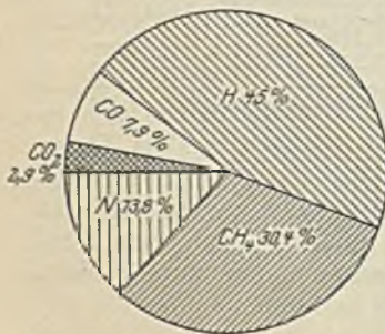
Volumenprozent. Heizwert von 1 cbm Gas = 4534 WE Gewichtprozent. Heizwert von 1 kg Gas = 7675 WE Schaubild 3. Koksofengas.
