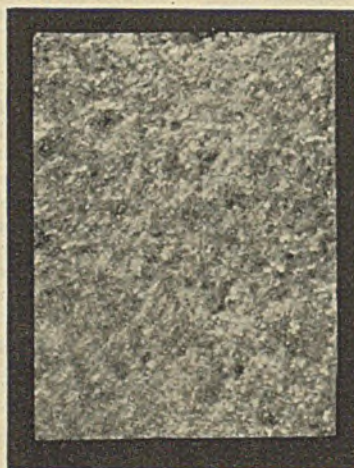
Abbildung 7. Weißes Roh Eisen, geglüht. Gießtemperatur 1230° C. Max. Festigkeit 45,56 kg/qmm.
