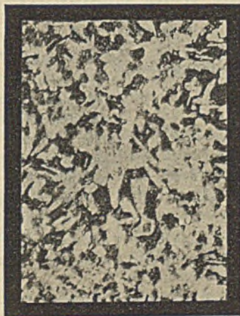
Abbildung 15. Stahl Nr. 88 a, Dehnung 20,0%.
