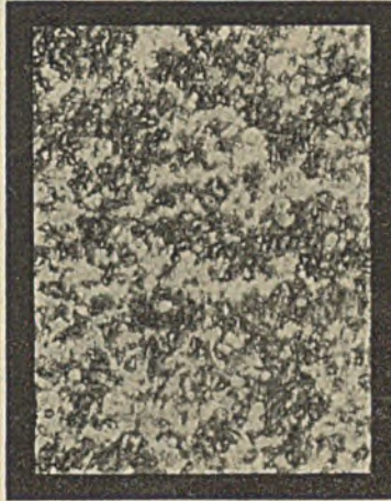
Abbildung 12. Stahl Nr. 85 a, Dehnung 33,5%.
