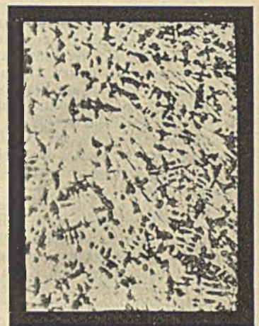
Abbildung 5. Weißes Roh Eisen. Gießtemperatur 1120° C. Max. Festigkeit 18,89 kg/qmm.
