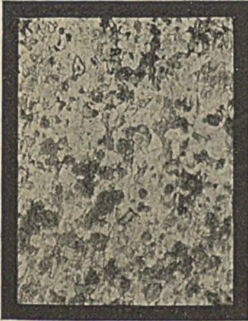
Abbildung 11. Stahl Nr. 84 a, Dehnung 15,5%.
