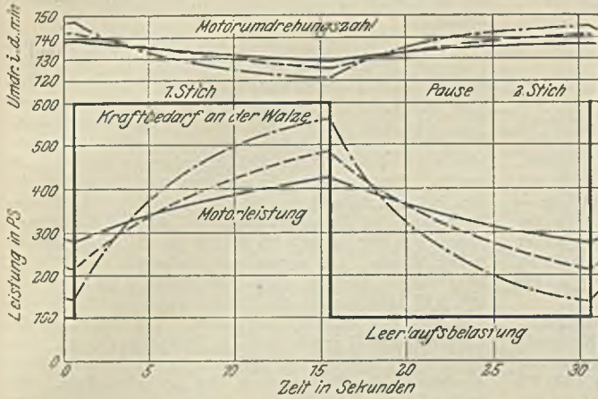
Abbildung 1. Arbeitsweise eines stetigen Schlupfreglers.
