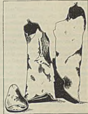
Abbildung 3. Durch Feuer zur Explosion gebrachte Stahlflaschen.
