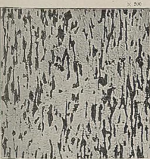
Abbildung 11. Gefügebild dieses Elektrostahles nach viermaligem Ziehen.
