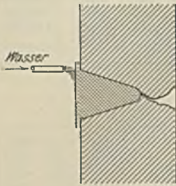
Abbildung 1. Mit Eisen vergossenes Durchbruchloch.
