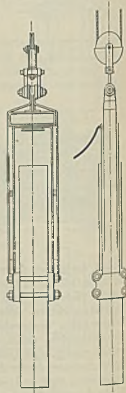
Abbildung 34. Stromanschluß nach Natusius.
