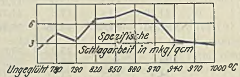
Abbildung 2. Ergebnisse der Kerbschlagbiegeversuche. Stahlguß mit 0,23 % Kohlenstoff.
