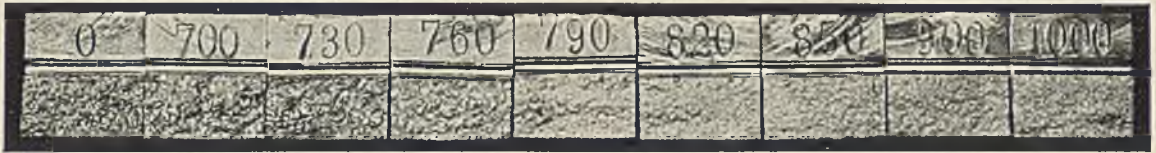
Abbildung 7. Bruchgefüge der Schlagproben des Stahlgusses mit 0,66 % C nach Erhitzen auf verschiedene Temperaturen.
