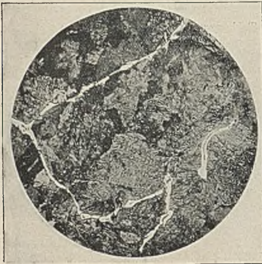
Abbildung 13. Stahlguß bei 730 ° C geglöht.
