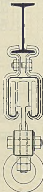
Abbildung 3. Zweischienenhängebahn in Form eines Doppelrillengleises, Bauart Tourtellier.
