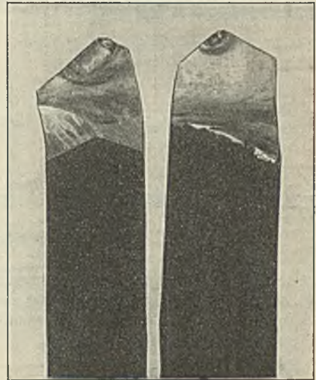
Abbildung 8. Vergleich der Abnutzungserscheinungen bei Schnellstählen beim Arbeiten auf Maschinenstahl (links) und auf Chrom-Nickelstahl (rechts).
