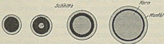
Abbildung 2. Verbrauch an Formmaterial durch hohle Gußkugeln gleicher Masse.
