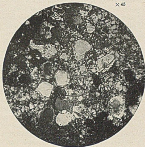
Abbildung 2. Quarzit mittlerer Güte (II). Quarzit- körner mit Anwachszone in etwas körnigem Zement. Gekreuzte Nicols.
