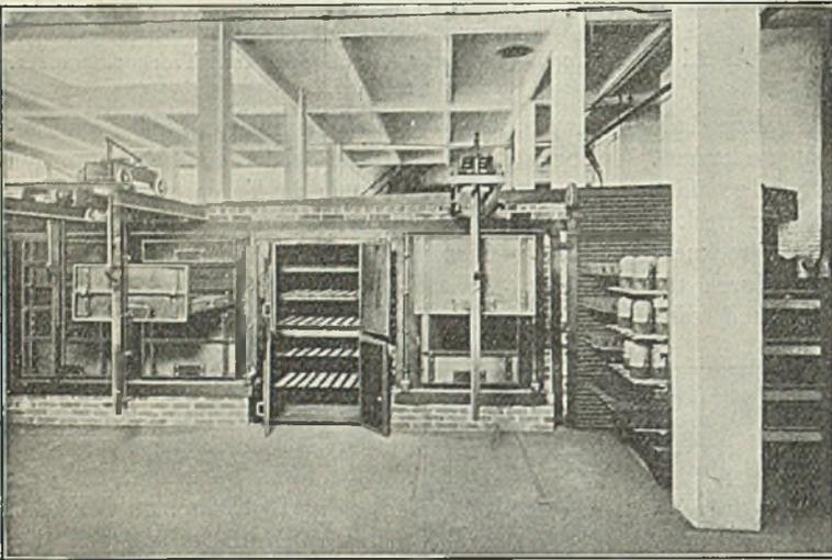
Abbildung 6. Trockenkammer mit Schublädenrosten.
