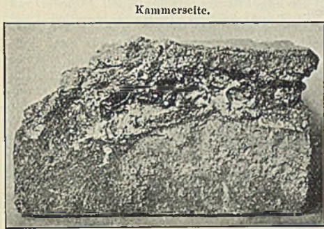
Abbildung 1. Veränderung eines Koksofensteines.
