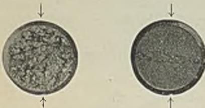
Abbildung 2 und 3. Bruch einer Kerbschlagprobe aus Schweißseisen.
