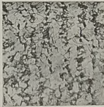
Abbildung 25. Nickelstahl I, bei 780° gegläht.
