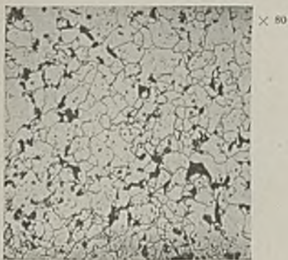
Abbildung 1. Material I, wenig Schlackeneinschlüsse, im gegossenen Zustande.
