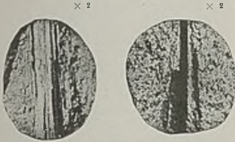
Abbildung 16 und 17. Schleferbruch in weichem und hartem Material.
