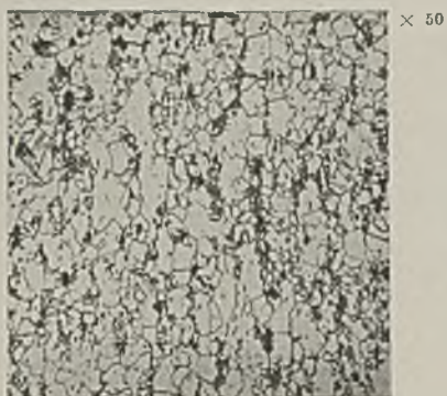
Abbildung 3. Material I, geschmiedet und bei 950° geglüht. Schwach ausgeprägte Zeilen.
