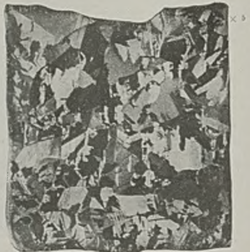
Abbildung 14. Dasselbe Material, bei 1450° abgeschreckt, mit Salpetersäure in Amylalkohol geätzt.
