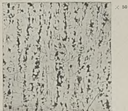
Abbildung 6. Material II, geschmiedet und bei 875° geglüht. Stark ausgeprägte Zeilen.
