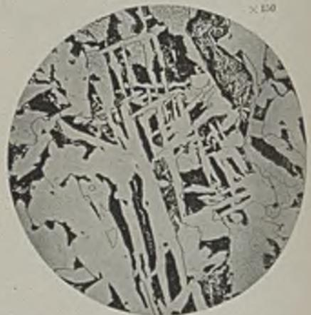
Abbildung 29. Material IV, bei 1050° gegläht.
