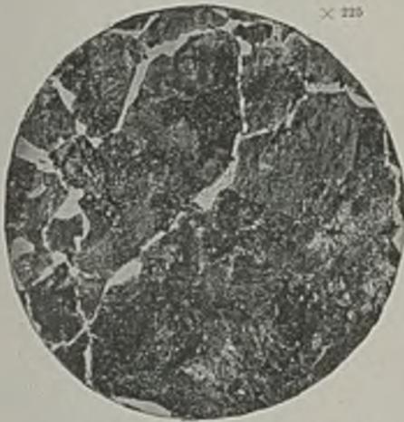
Abbildung 16. Material II, bei 880° gegläht.
