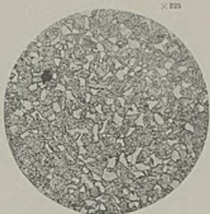
Abbildung 6. Flußeisen, auf 980° erhitzt, bei 840° abgeschreckt.
