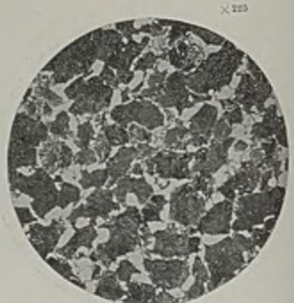
Abbildung 15. Material II, bei 775° gegläht.
