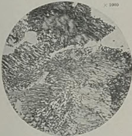
Abbildung 18. Material II, bei 775° gegläht.
