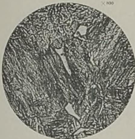
Abbildung 2. Material XI, bei 780° abgeschreckt.
