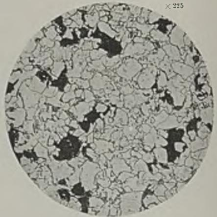
Abbildung 10. Material J, bei 790° gegläht.
