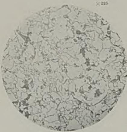
Abbildung 9. Material I, bei 700° gegläht.
