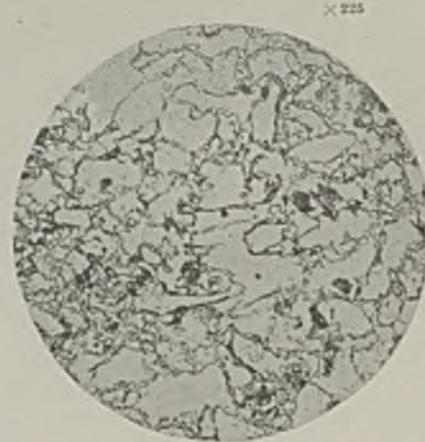
Abbildung 8. Material I, bei 700° geglüht.
