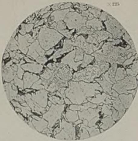
Abbildung 23. Material III, bei 850° gegläht.
