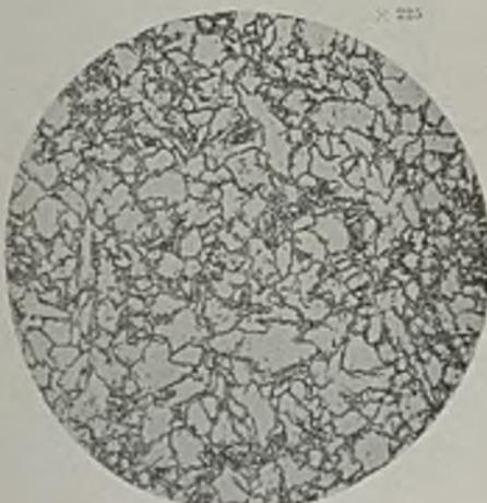
Abbildung 21. Material III, bei 680° gegläht.
