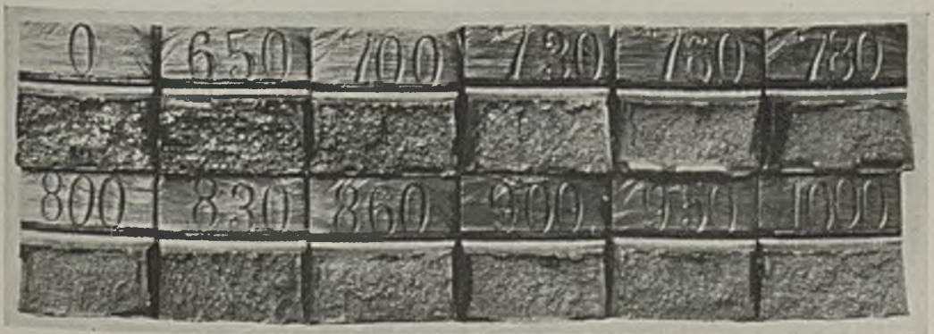
Abbildung 37. Kerbschlagproben von Material VI.
