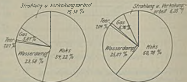
Abbildung 6 und 7. Verkokungswärme bei Versuch 1 und 2.
