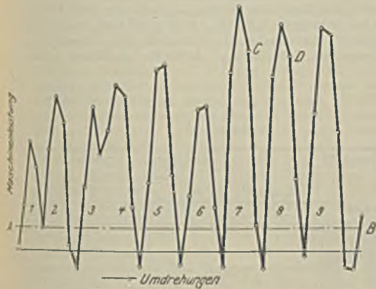
Abbildung 22. Schaubild der Walzarbeit nach Coryell.
