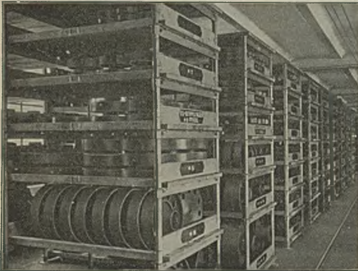
Abbildung 14. Lagergestelle mit veränderlicher Fachhöhe, „Bauart Sulzer“.
