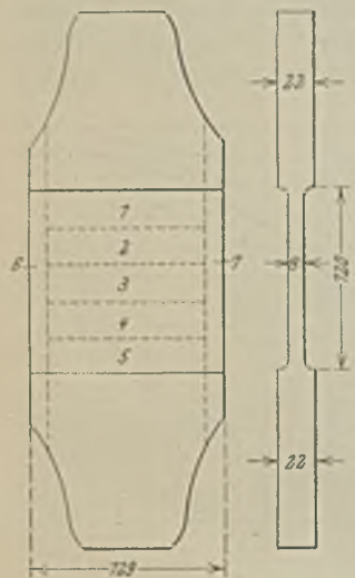
Abbildung 2. Probenahme zur Feststellung betreffs Krafrichtung und Materialbeanspruchung.
