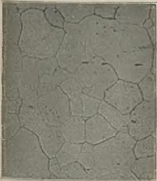
Abbildung 9. Flußeisen, 15 Tage lang geglüht (Mitte).
