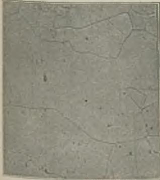
Abbildung 10. Flußeisen, 25 Tage lang geglüht (Mitte).
