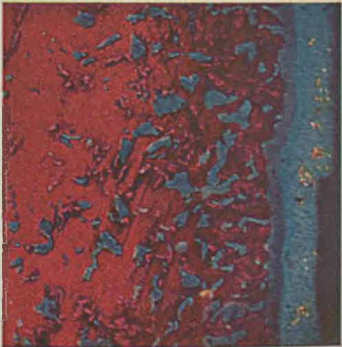
B 10 Abbildung 51. Elektrolytisen, 8 st bei 850° nitriert. Ferrit rot, Nitrid blau, Zementit violett.
