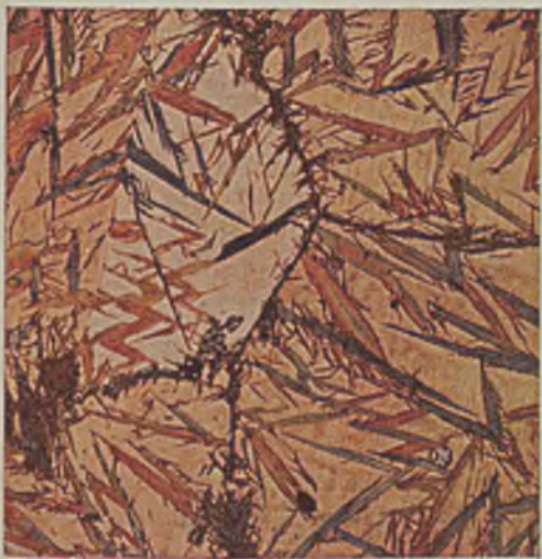
B 3 Abbildung 14. Stahl mit 1,5% C, bei 1150° in Wasser gehärtet. Austenit, Martensit.
