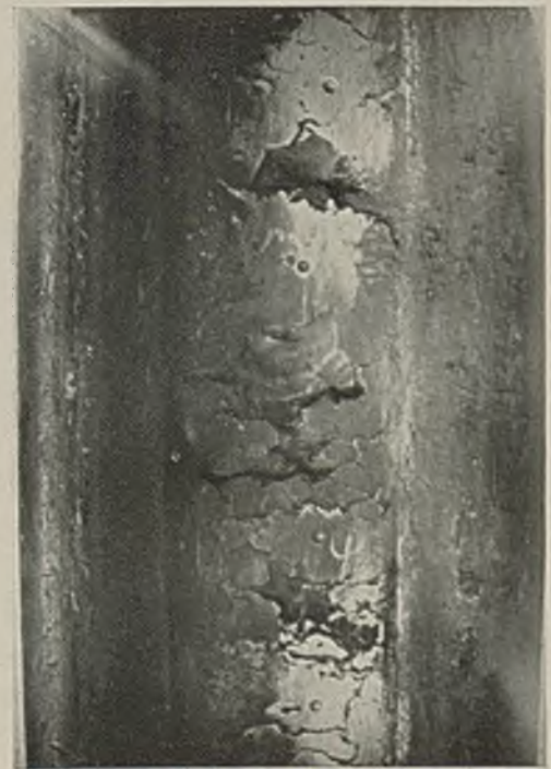
Abbildung 36. Geätzter Querschliff eines Eisenbahnrades. Gequetschte Fasern an der Lauffläche.
