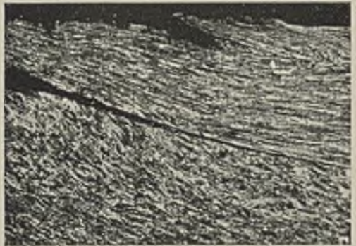
Abbildung 36. Geätzter Querschliff eines Eisenbahnrades. Gequetschte Fasern an der Lauffläche.
