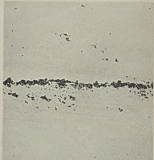
Abbildung 43. Tonerde-Einschlüsse in gewalztem Flußeisen.
