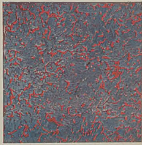
B 2 Abbildung 10. Stahl mit 1,5% C. Perlit blau, Zementit rot.
