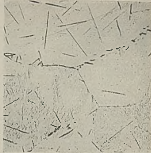
Abbildung 58. Elektrolyteisen, bei 750° nitriert; schwarz geätzt.
