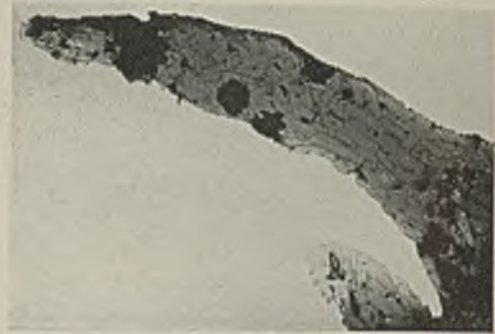
Abbildung 41. Einschuß von Ofenschlacke im Stahl.
