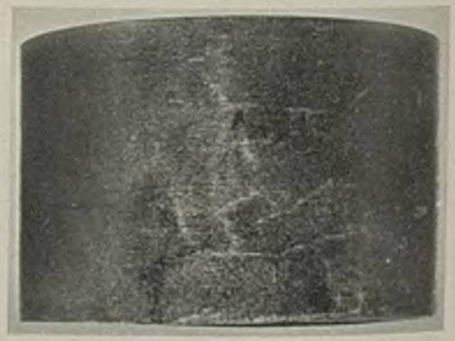
Abbildung 32. Uebereiteter Abschnitt einer gebrauchten Lokomotivachse. Risse auf der Oberfläche.
