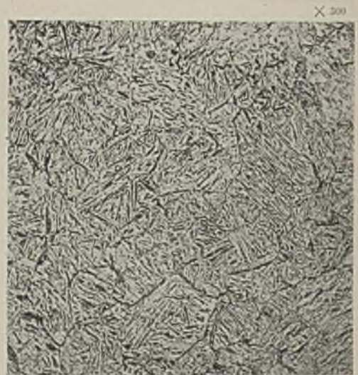
Abbildung 30. Gefüge an der aufgeschweißten Stelle des Rohrs.
