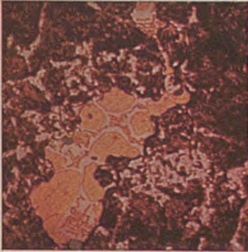
B 7 Abbildung 33. Abschnitt einer Lokomotivachse mit Bronzeinschlüssen.
