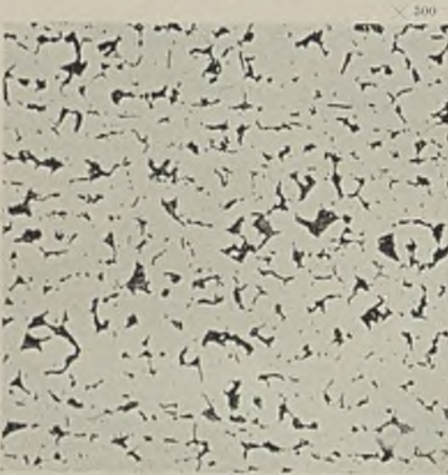
Abbildung 29. Normales Gefüge des Rohrs.
