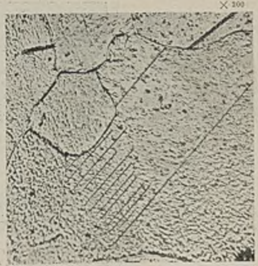
Abbildung 51. Elektrolyteisen, bei 750° nitriert schwach geätzt.
