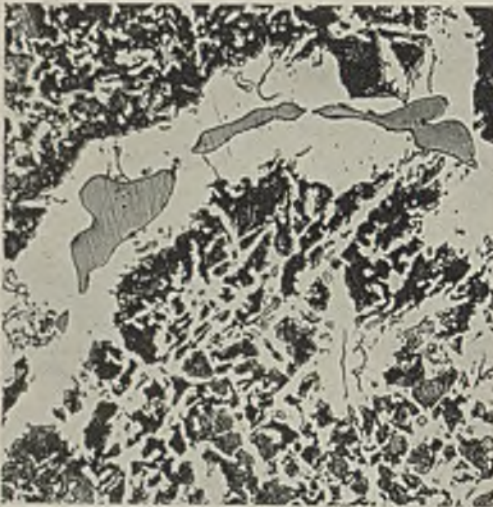
Abbildung 42. Manganeisensulfid-Einschuß im Stahlguß.
