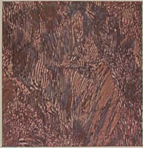
B 1 Abbildung 5. Stahl mit 0,9% C. Perlit.
