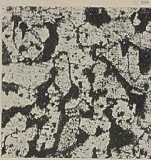
Abbildung 27. Kohlenstoffstahl, gegliht, mit 0,20 % C.
