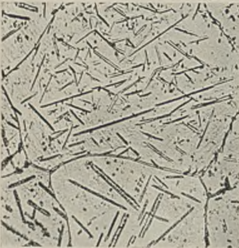
Abbildung 59. Elektrolyteisen, bei 750° nitriert; tief geätzt.
