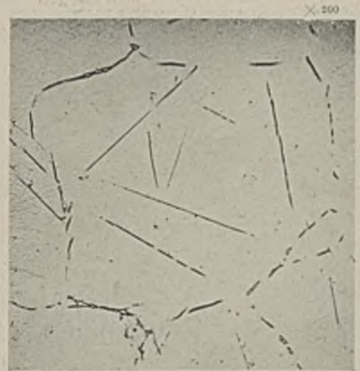
Abbildung 51. Elektrolyteisen, bei 750° nitriert schwach geätzt.
