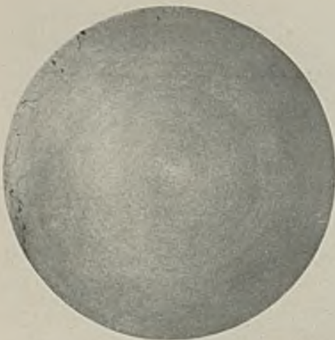
Abbildung 31. Abschnitt einer gebrauchten Lokomotivachse, mit Kupferammoniumchlorid gelätzt. Risse in der Randschicht.
