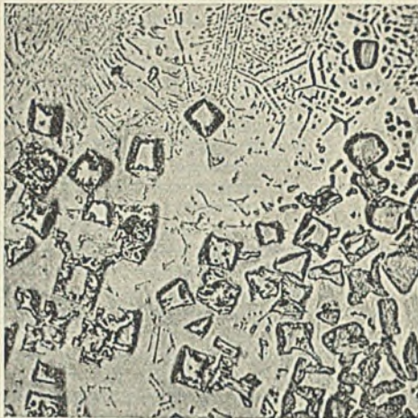
Abbildung 1. Ferrotitan, mit 10 % Titan nitriert.
