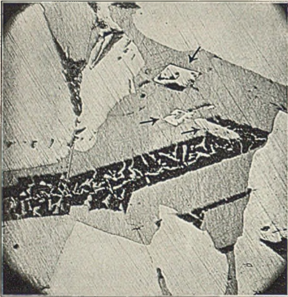
Abbildung 11. Zinnsäurekristalle in einer Legierung mit 10% Zinn, 30% Antimon, 10% Blei.
