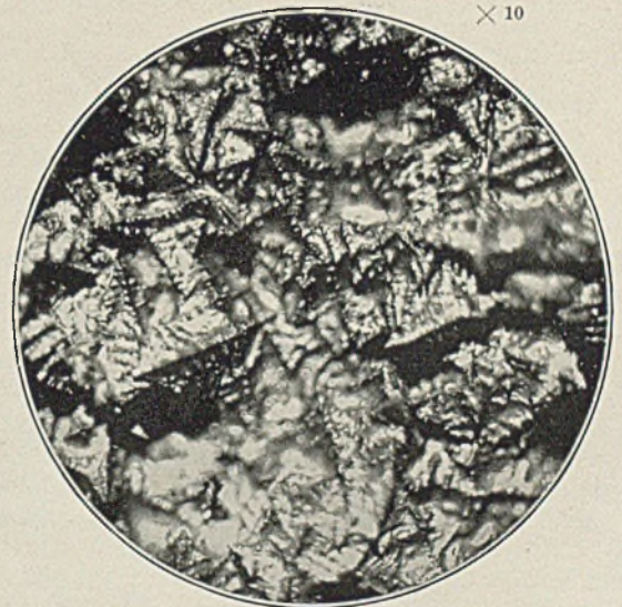
Abbildung 5. Vergrößerung des Lunkers von Abb. 4.
