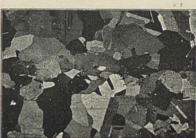
Abbildung 2. Kristallfelder-Aetzung.  $\alpha$ -Messing; die einzelnen Kristalle werden infolge ungleicher Oberflächen-Reflexion durch Helligkeitsunterschiede angezeigt. Geätzt mit 10prozentiger Ammoniumpersulfatlösung.
