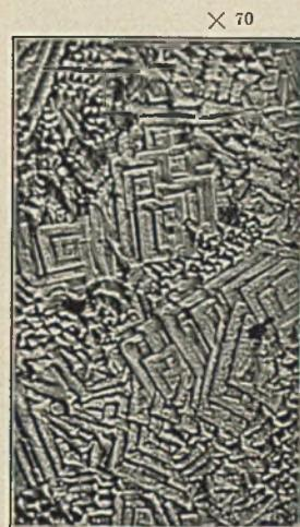
Abbildung 7. Wismutkristalle mit kennzeichnenden mäanderlinienartigen Skeletten.
