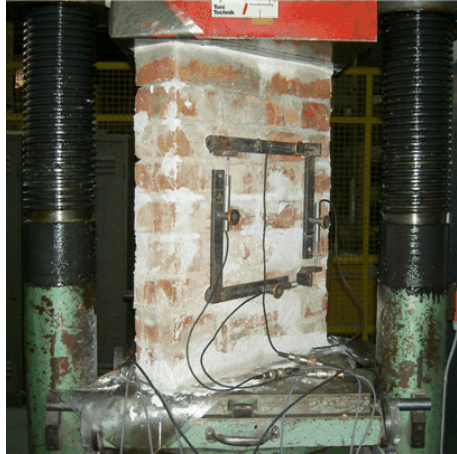
Rys. 3.13 Stanowisko badawcze muru podczas próby cyklicznego ściskania 28.03.2006r.
