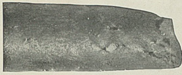
Abbildung 3. ZerreiBprobe mit Schlackenriß.
