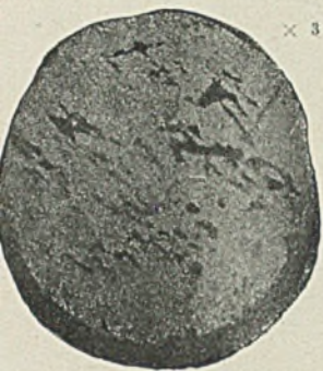
Abbildung 2. Probe Abbildung 1 nach dem Vergilten.
