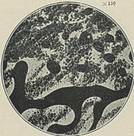
Abbildung 5. Gasteer, durch Trocknen bei 110° eingedickt; aufgenommen bei rd. 46°.
