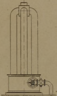
Abb. 1. Großraum-Heizofen mit Gasfeuerung für kleine Leistungen.
