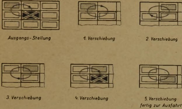
Abb. 19. Turmgarage nach engl. Vorschlag. Abb. 21 (hierunter). Aufzugsanlage für Großgarage.
